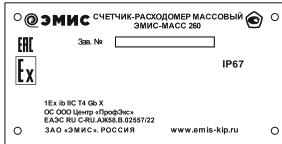
Рисунок 1.4 - Табличка с маркировкой датчика
